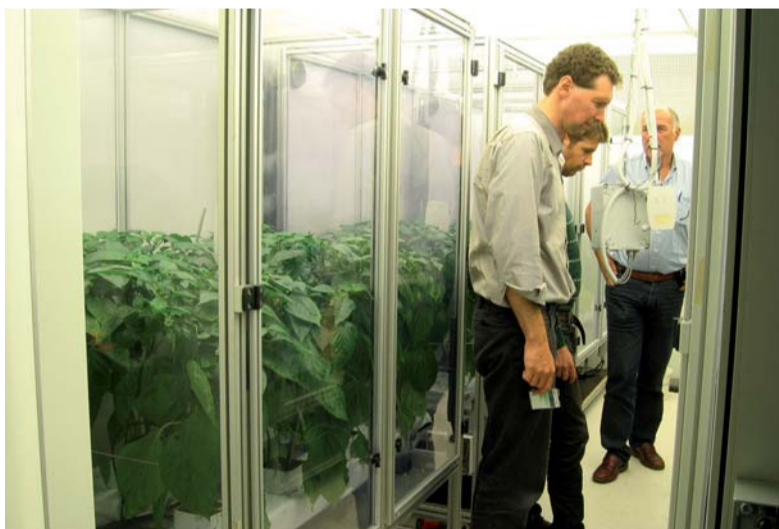
Uit begassingsonderzoek blijkt dat piekbelastingen met langere tussenpozen minder schadelijk zijn dan continu hoge concentraties rookgassen.
