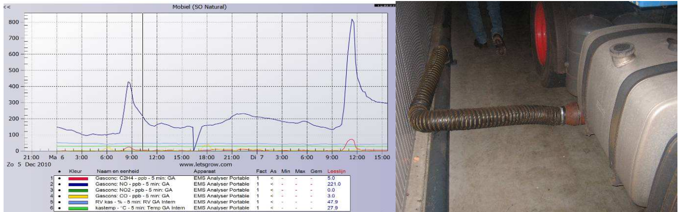
Figuur 1 Op 6 december 2010 tussen 8:00 uur en 9:30 uur en tevens op dinsdag 7 december 2010 tussen 10:00 uur en 12:00 uur vinden er bark lossingen plaats. Naast grote NO (blauw) pieken zijn er ook grote etheen (rood) pieken waarneembaar.
